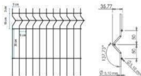
De acordo com o projeto padrão fornecido (para terreno de 45 x 35 m), haverá fechamento com gradil de 1,58m de altura, com pilares metálicos e tela de aço galvanizado de tamanho fixo, instalado na parte frontal do lote, acima de mureta de alvenaria de 0,62m de altura. Caso o terreno disponível seja maior, o ente requerente poderá utilizar-se do padrão de fechamento aqui descrito para a instalação em todo o seu terreno, ficando o custeio do excedente a cargo do requerente.
