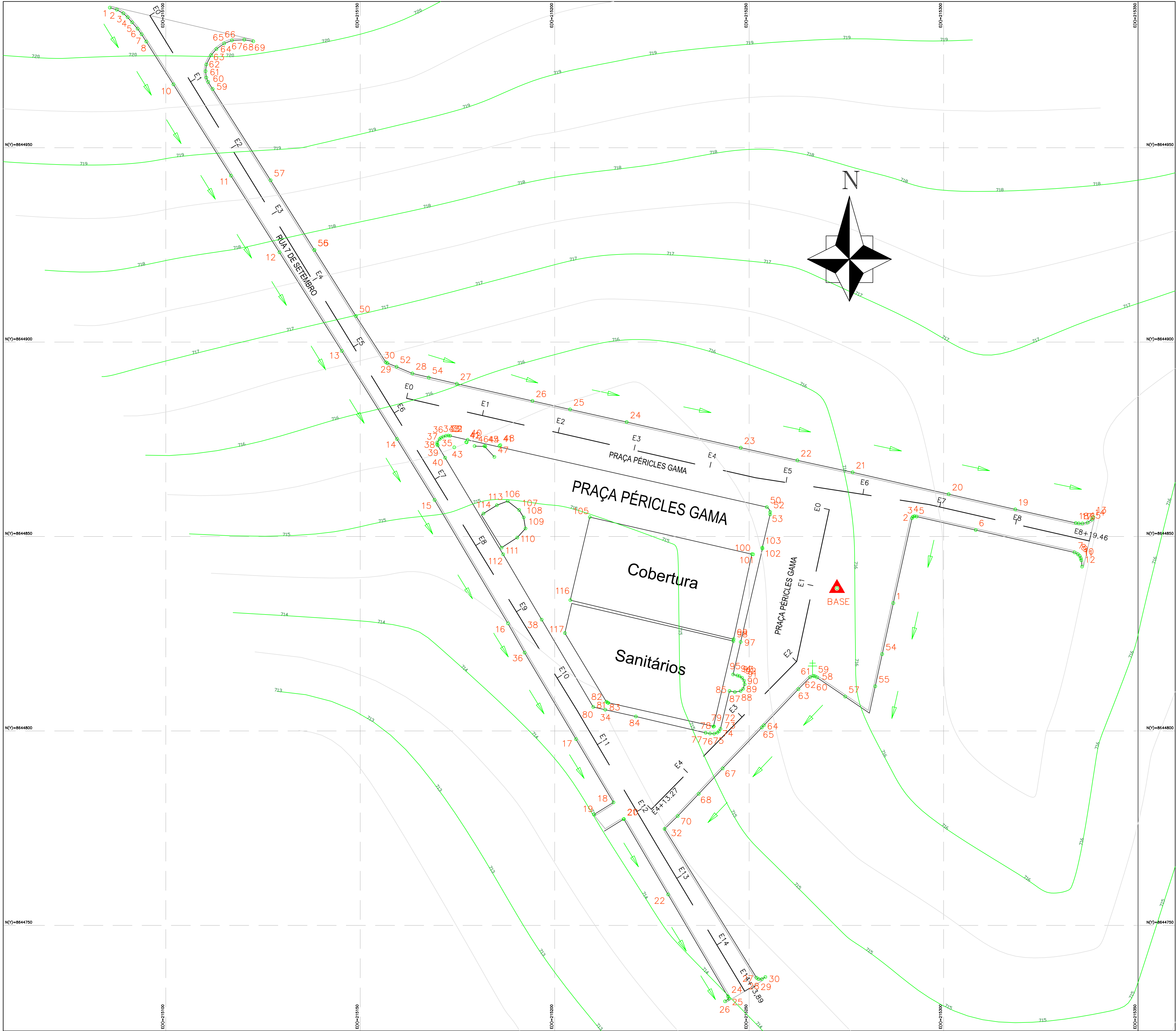
LEVANTAMENTO PLANIALTIMÉTRICO ESCALA: 1/500
